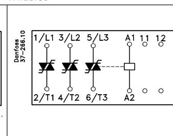
Los bornes 11 y 12 no están conectados al circuito interno y están preparados para una conexión opcional de protección por sobrecarga ( ver las instrucciones sobre protección térmica, pág. 4).
