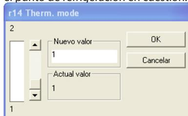
El valor actual se muestra en el campo inferior, y en el campo superior se muestra un valor que se puede cambiar moviendo el cursor de la izquierda, o introduciendo un nuevo valor en el campo. Cuando se ha ajustado el valor nuevo, pulsar OK. El controlador del servicio de refrigeración cambiará automáticamente la temperatura.
