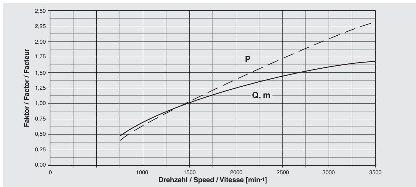
Die Verdichter sind optimiert für den Einsatz mit Fahrzeugmotor bei variabler Drehzahl.
