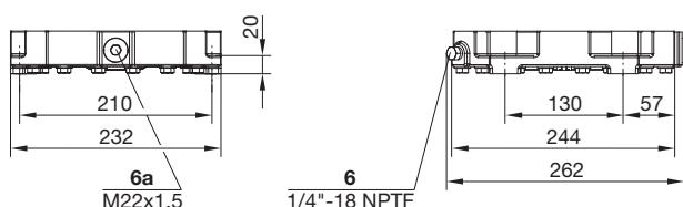
Bei Verwendung der optionalen Bodenplatte bleibt die Gesamthöhe des Verdichters unverändert.
