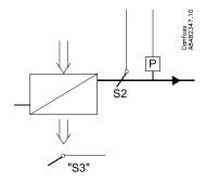
«о56» = 2 Данный режим рекомендуется при необходимости поддержания перегрева с большой точностью. При этом необходимо установить датчик температуры S3 на выходе охлаждаемой среды. В данном режиме используется т.н. «внутренний контур» регулирования, использующий температуры S3 и To.
