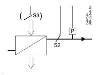
«о56» = 1 Данный алгоритм регулирования использует классический метод (давление и температура хладагента на выходе) и рекомендуется для отработанных систем.
